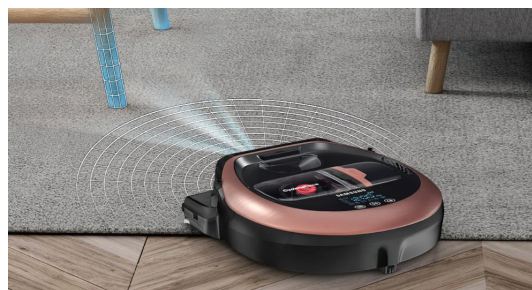
تصویر ۸. یک جارو ربات هوشمند در حال شناسایی محیط اطراف خود (www.samsung.com)
