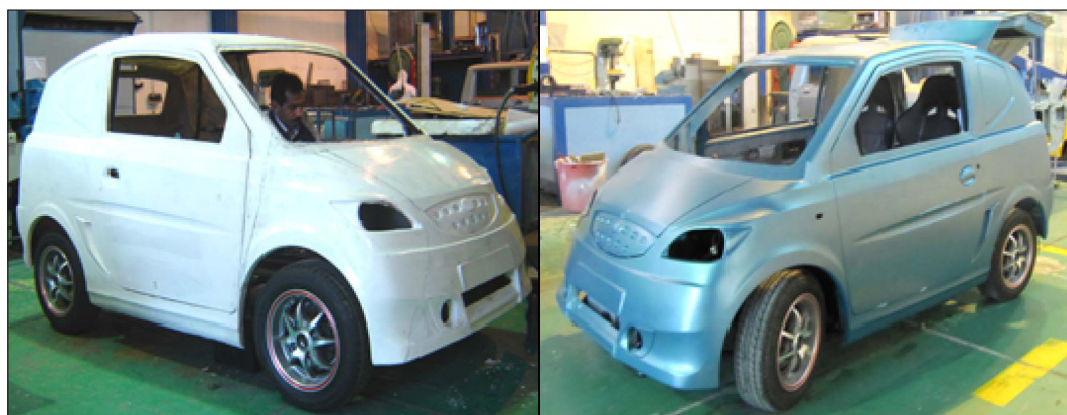
(تصویر ۲۳) اتصال بدنه به شاسی. ساخت و نصب تجهیزات داخلی (قفل و لولاها، براکت چراغ‌های جلو عقب و...)
