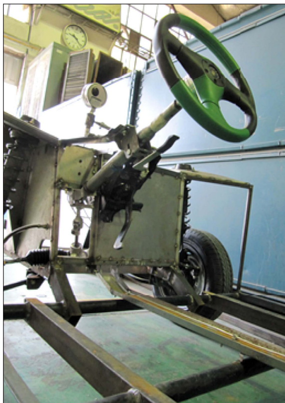
تصاویر ۱۳) شاسی خودرو، چرخ‌ها، سیستم تعلیق، فنربندی
