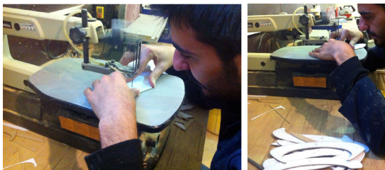
تصویر ۱۲: برش لایه‌ها به کمک دستگاه اره مویی رومیزی
