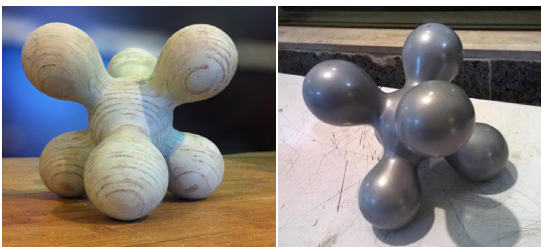
تصویر ۲۶. مدلی با پیچیدگی فرمی زیاد که سطح آن به صافی مورد نظر برای بتونه فوری و سپس رنگ نهایی رسیده است (تصویر چپ)؛ سطح مدل پس از رنگ آمیزی (تصویر راست) (کار پایان ترم واحد مدل سازی ۱ دانشجو مسعود قزلباش)
