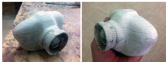
تصویر ۲۱. پله های قسمت بالایی مدل دوربین عکاسی با بتونه سنگی پر شده است
