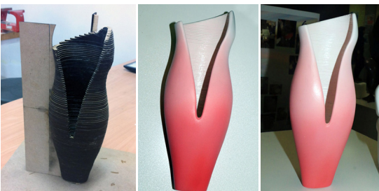
تصویر ۲۷. ساخت مدلی با مقیاس واقعی از چراغ رومیزی؛ استفاده از شابلون جهت چینی لایه ها (تصویر چپ)؛ اتمام ساخت مدل (تصویر راست) (کار پایان ترم واحد مدل سازی ۱ دانشجو فرزانه رشیدی)
