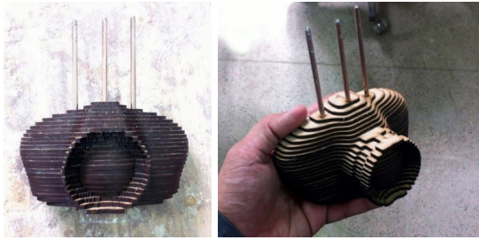
تصویر ۱۶. اتمام مرحله چینش و چسب کاری لایه ها در مدل دوربین عکاسی
