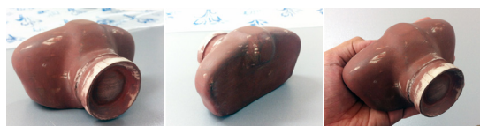
تصویر ۲۲. سطح مدل دوربین عکاسی بتونه و سنباده زده شده است و برای رنگ کاری آماده است
