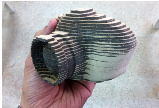
تصویر ۱۹. لایه های قسمت پایینی مدل دوربین عکاسی با ساییدن یکدست شده است
