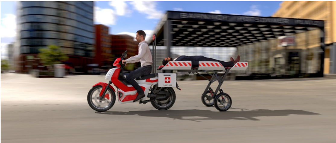
شکل ۵. نمونه اولیه پیشنهادی طراحی موتور آمبولانس با قابلیت حمل مصدوم
